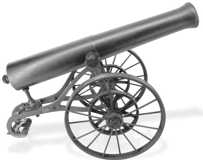
Рис. 3. Модель 24-фунтового орудия крепостной артиллерии на лафете Венгловского. Александровский пушечный завод. Петрозаводск. 1847 г. Масштаб 1:8. Из коллекции Горного музея
